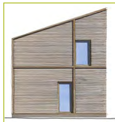
A droite : bardage horizontal dans une trame carrée
